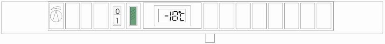
Der Thermostat kann auf eine Skala von 1-7 eingestellt werden, das entspricht ca. -15 bis -25°C.
